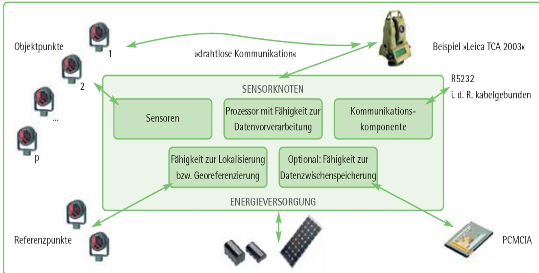
Abb. 3: Motorisiertes Tachymeter als Sensorknoten bei Überwachungsaufgaben
