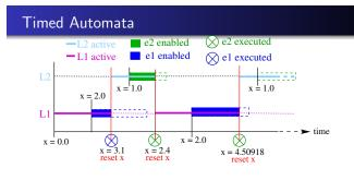
$$\langle L_1, 0 \rangle \xrightarrow{3.1} \langle L_1, 3.1 \rangle \xrightarrow{e_1} \langle L_2, 0 \rangle \xrightarrow{2.4} \langle L_2, 2.4 \rangle \xrightarrow{e_1} \langle L_1, 0 \rangle \cdots$$
