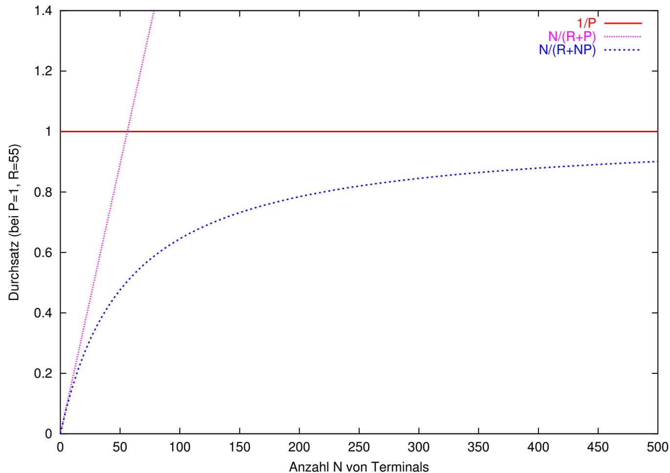
Maximal erzielbarer Durchsatz erfüllt  $\frac{N}{R+NP} \leq \lambda \leq \min \left\{ \frac{N}{R+P}, \frac{1}{P} \right\}$ .
